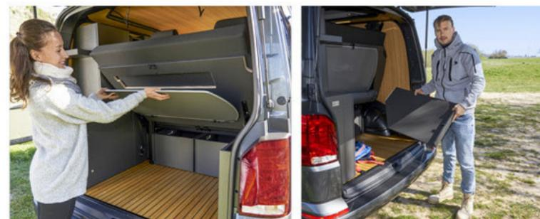
Die hochgeklappte Heckablage samt Tisch vergrößert das Stauraumvolumen. Mehr Ladebreite entsteht durch Abnehmen des seitlichen Verkleidungsbretts.
