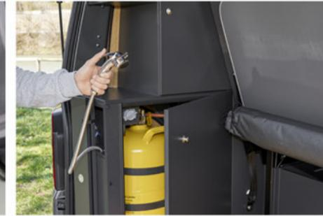
Links im Heck sind die Elf-Kilo-Gasflasche untergebracht sowie der Frischwasser-Einfüllstutzen.
