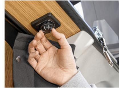
Die Funktionen der Heizung lassen sich über einen Drehknopf nahe der B-Säule regeln.
