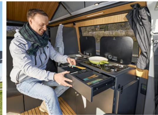
Die beiden Tischplatten haften über Magnete an der Stirnseite der Küchenzeile. Die Schubladen haben keine Tasten oder Griffe: Sie werden über Federstahllaschen entriegelt.
