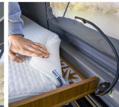
Das optionale Aufstelldach öffnet manuell mit Gasdruckfeder-Unterstützung. Der Aufstieg erfolgt über die Fahrerhausitze. Die Matratze misst 185 x 110 Zentimeter und ist komfortabel gefedert. Eine LED-Leuchte sorgt am Abend für Leselicht.
