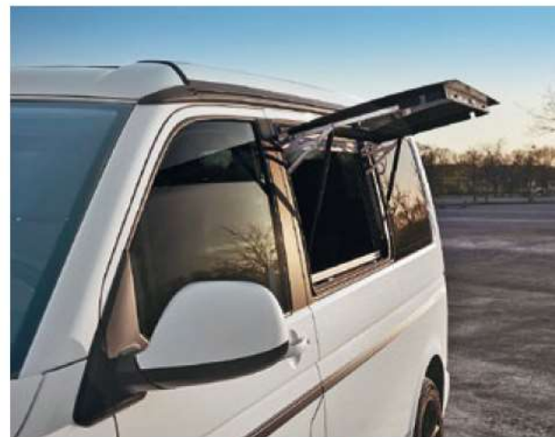
Das eigens konstruierte Ausstellfenster aus Echtglas ist künftig serienmäßig in allen Custom-Bus-Modellen auf der Fahrerseite verbaut.
